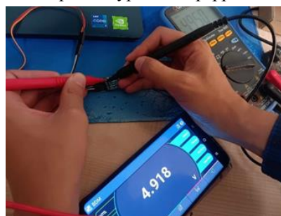
10-р зураг. Мультиметр болон гар утас хоёрын хоорондох холболтын туршилт
